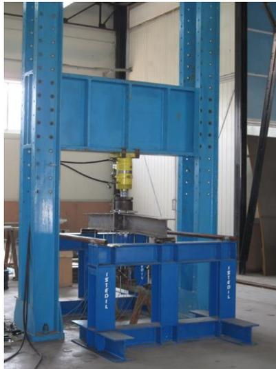
**Figura 10.** Macchina di prova a controllo di spostamento in laboratorio.
